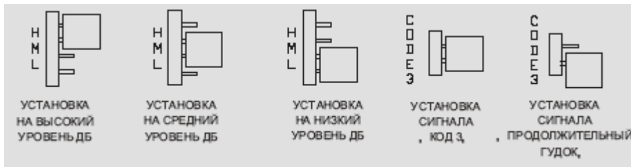
Рис 4: Установка переключателей для высокого, среднего и низкого уровня звукового давления, а также звукового сигнала код 3 и продолжительного звукового сигнала.
