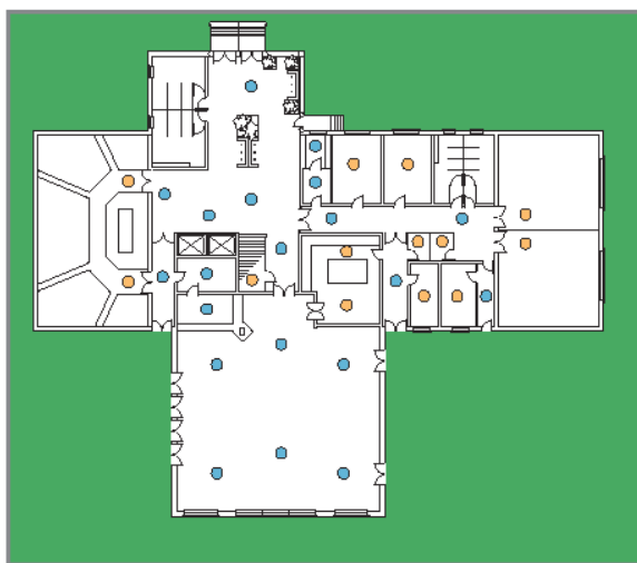
Типовые примеры расстановки извещателей для системы категории L2
