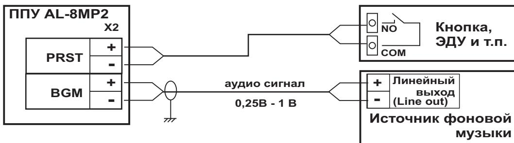
**Примечание:** По умолчанию, аудио сигнал, поступающий от источника фоновой музыки, в соответствии с программными настройками, будет транслироваться в установленных для "Пресета 1" зонах. При замыкании контакта, фоновая музыка будет звучать только в тех зонах, которые были выбраны в программных настройках для "Пресета 2".
