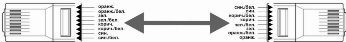
Рис. 6. Схема подключения вилки RJ45
