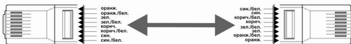
Рис. 6. Схема подключения вилки RJ45
