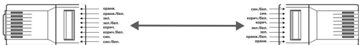
Рис. 4. Схема подключения вилки RJ45
