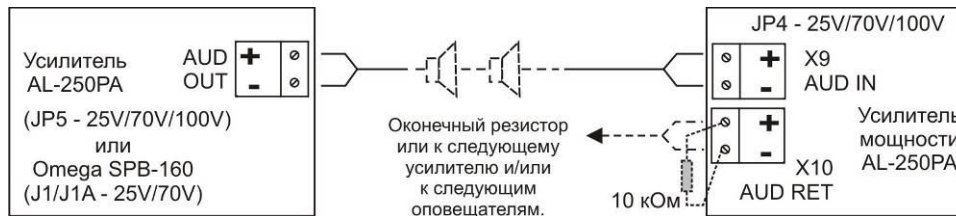
Рис.7г Пример подключения к аудио выходу другого усилителя AL-250PA или Omega SPB-160. Усилитель AL-250PA работает в режиме «Зональный» (см. п.4.2)
